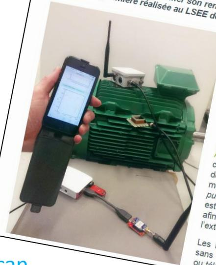
A l'heure où les objets sont connectés, le LSEE (Laboratoire Systèmes Electrotechniques et Environnement) instrumente à distance les moteurs électriques de l'industrie !
